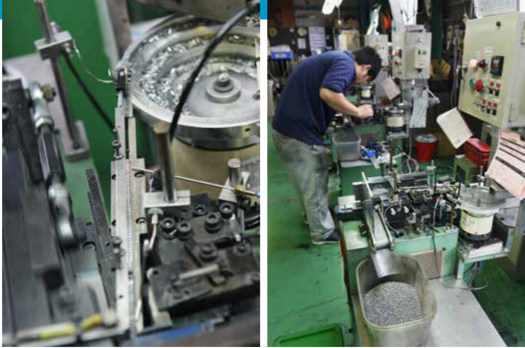
超マイクロサイズのネジを効率よく生産する機械は市販されておらず、オーダーすると非常に高額となるため、ミスキでは自作を試みた。微小なネジを一点ずつ流すパーツフィーダーの製作に苦労したが、作り手の視点に立った、使い勝手のよい機械が100万円程度で完成。自作機械は全部で7台となり、大幅なコスト削減となった。
