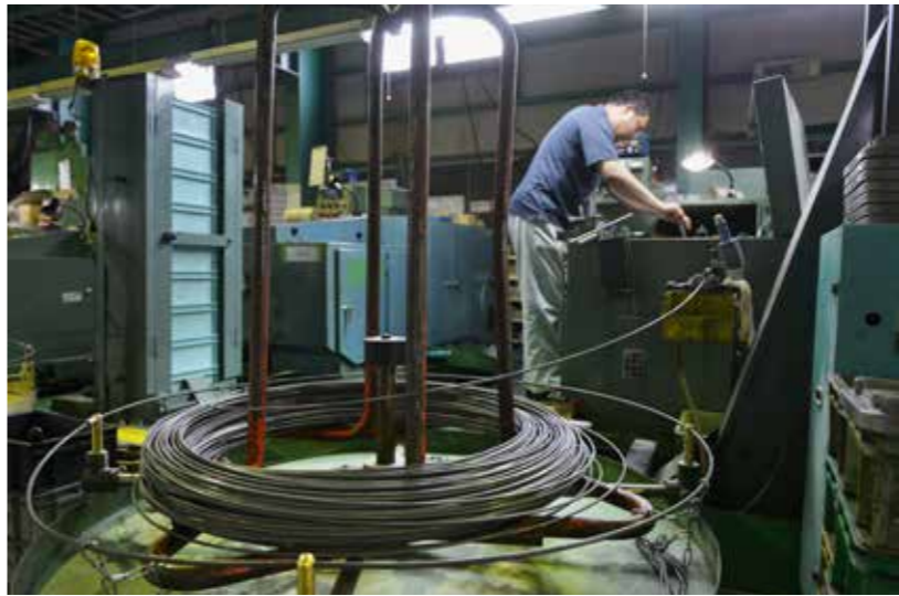
(写真上) ミズキのシャフト作りは、コイル状に巻かれた線材を切断し、研磨して一気に仕上げる。棒材を製品寸法に近いサイズに切断して仕上げる一般的な製法と違い、無駄な端材が出ず、製造時間も半分以下ですむため生産性が高い。(下) 「不良ゼロ」を目標に掲げ、様々な取り組みをおこなっている。写真の自社で製作した画像選別機もその一つ。上面カメラと側面カメラで不良品を選別する。超マイクロサイズのネジも毎分500本以上検査可能となり、不良ゼロ化に大きく貢献した。
